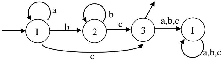
ce qui est le même automate que le résultat de compléter l'automate (A5) ! (en minimisant l'automate (A5), la seule chose qu'il reste à faire c'est de le compléter, autrement il est déjà minimal).
